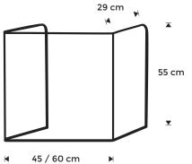
Mampara de protección especial para el alumnado. Fijación en las superficies de las mesas mediante sistema adhesivo de doble cara.
