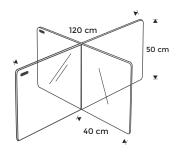
Paneles acrílicos de 5mm de espesor pensados para hostelería (restaurantes y cafeterías) proporcionando una máxima protección entre los comensales.
